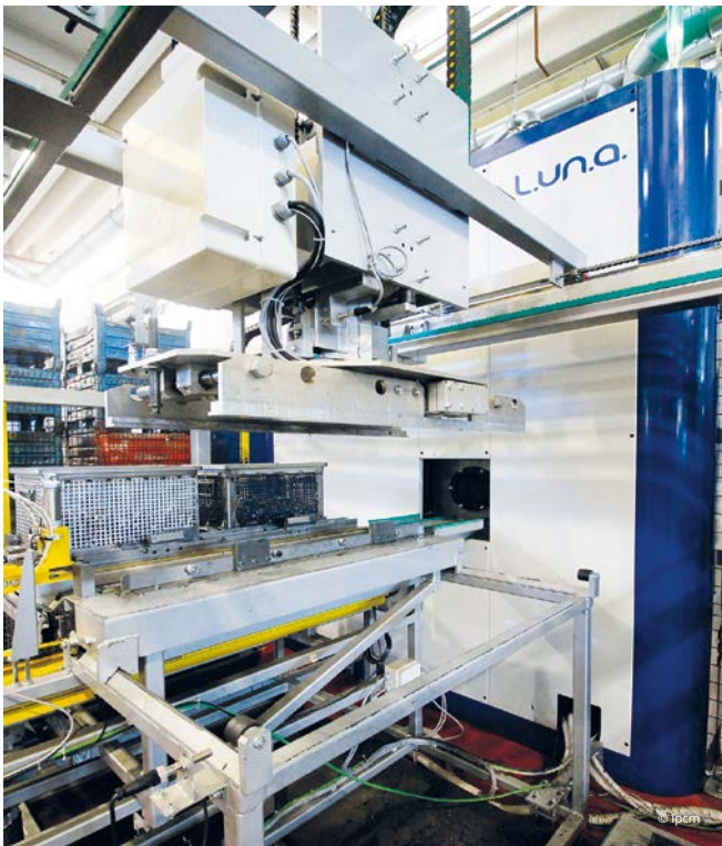
Baskets entering the single cleaning chamber. Ingresso dei cesti nella monocamera di lavaggio.
